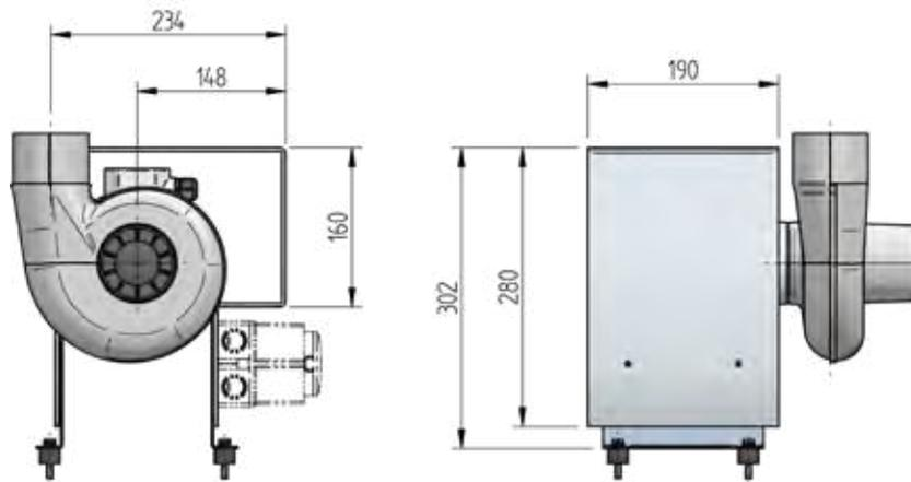
Les dimensions de la capot moteur de dimension Ø 110 sont identiques.
