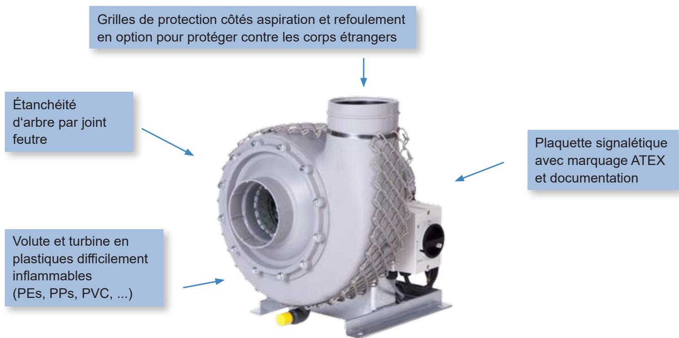
Les ventilateurs radiaux HF avec moteur EC ne sont disponibles pour le moment que pour la zone 2 à l'intérieur / aucune zone à l'extérieur (catégorie 3 à l'intérieur / aucune à l'extérieur).
